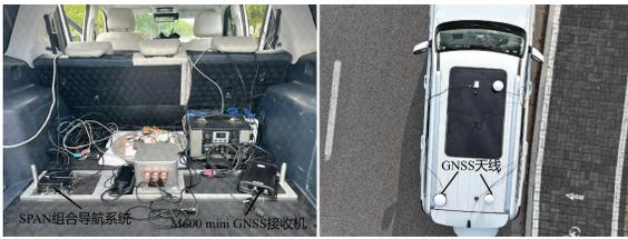
图 6 车载实验传感器配置
