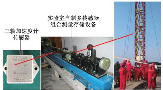
图 16 实钻井测试主要设备
