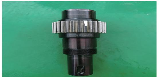
图 14 平行级小齿轮断齿
