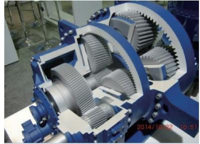
图1 风电齿轮箱结构图
