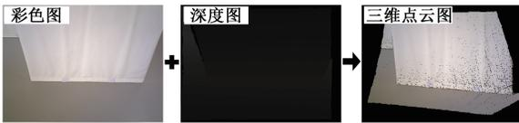
图 5 单帧三维点云生成示意图
