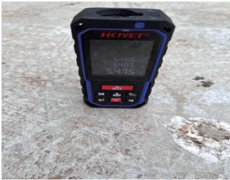
图 8 激光测距仪示意图
