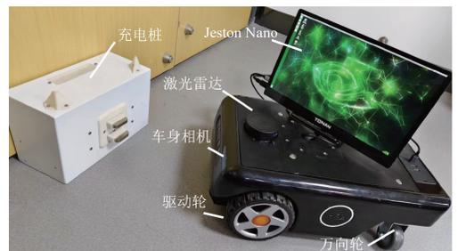
图3 无人车充电桩定位系统
