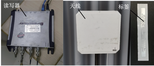
图 20 RFID 读写器、天线和 RFID 标签 Fig. 20 RFID readers, antennas and RFID tags
