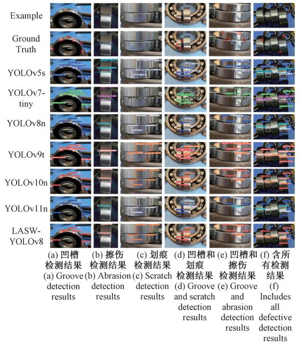
图 18 不同算法的缺陷检测结果
