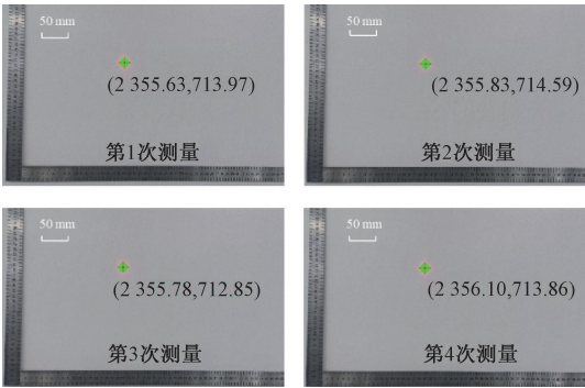
图 14 重复定位实验传感器数据采集 Fig. 14 Data acquisition of repeatability
