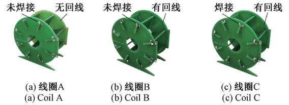
图 11 PCB 罗氏线圈实物
