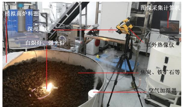
图 9 三维热成像系统组成
