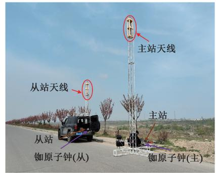
图7 动态无线时间比对试验站点布局
