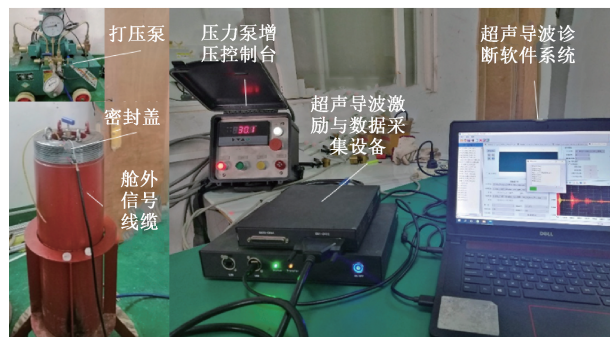
图5 压力测试实验装置
