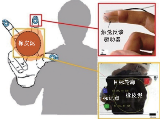
(b) 使用气体驱动器实现物体形状的反馈 (b) The interactive shape generation using SPA
