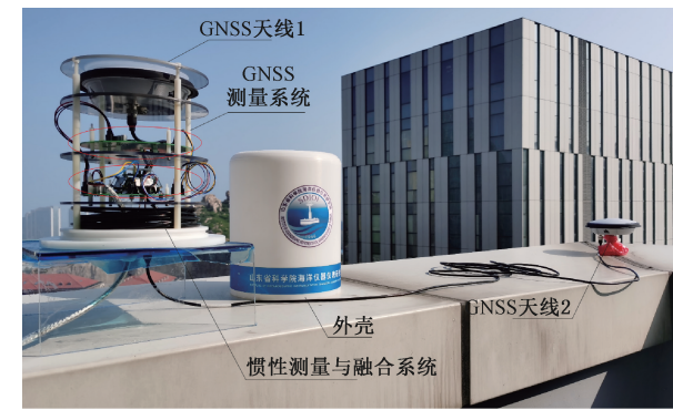
图 7 海洋浮标运动测量系统样机
