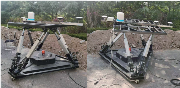
图 8 六自由度摇摆台运动比测实验
