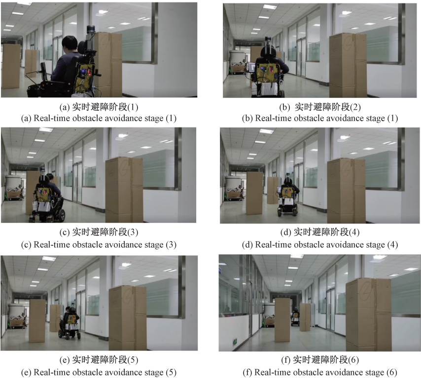
图 17 智能轮椅实时避障过程图(复杂大环境)
