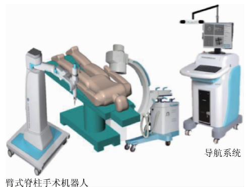
图3 脊柱手术辅助机器人 RSSS
