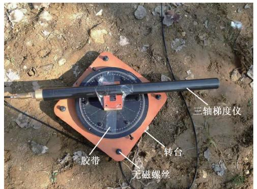
图 5 磁通门梯度仪及无磁转台
