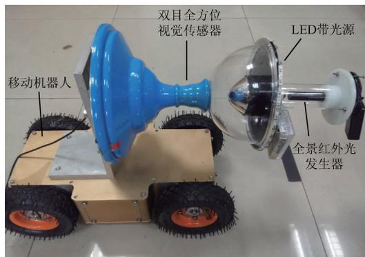
图1 视觉检测、识别和重构的管道机器人<sup>[5]</sup>
