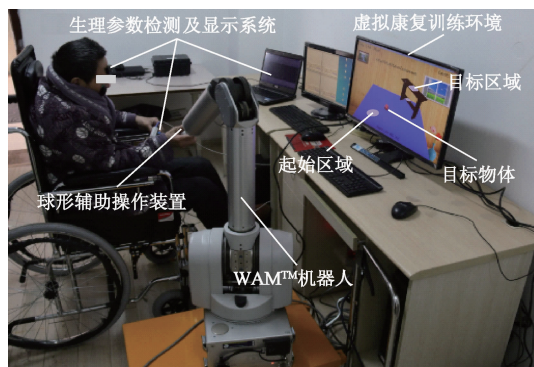
图1 基于焦虑情绪识别的机器人辅助临床康复训练系统
