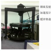
钢珠发射装置 加速度计安装基座
