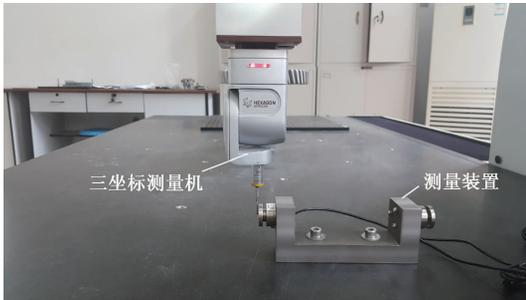
图7 正交式坐标测量机对长度标定实验
