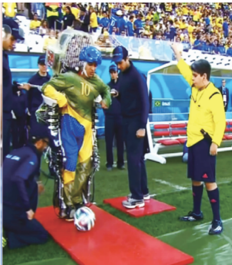
图9 BCI 技术辅助控制应用举例:利用 BCI-Exo 融合技术,瘫痪少年为 2014 年巴西世界杯开球
