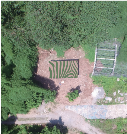
图 9 模型房直接映射的斑马纹伪装图案(起始代, 条纹与底色 RGB 三分量分别为[95,128,88]、[210,179,174])
