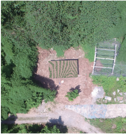
图 10 模型房遗传进化仿生伪装图案(第 30 代, 条纹与底色 RGB 三分量分别为:[95,128,88]、[210,179,174])
