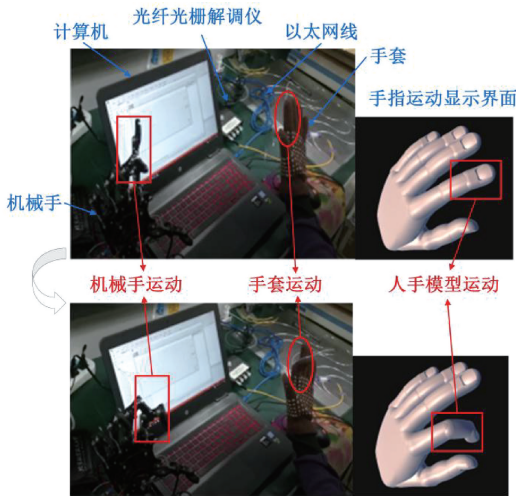
图9 基于光纤光栅传感器的机械手远程操控系统实物图
