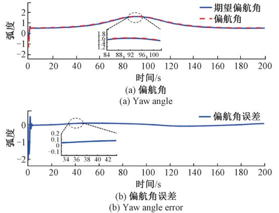
图 5 基于障碍的自适应积分制导律的偏航角误差
