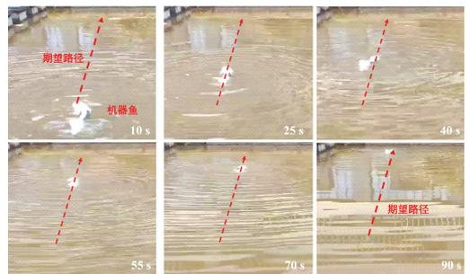
图 10 机器鱼路径跟踪实验
