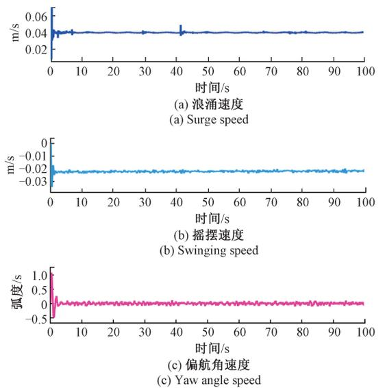
图 14 机器鱼的实验速度
