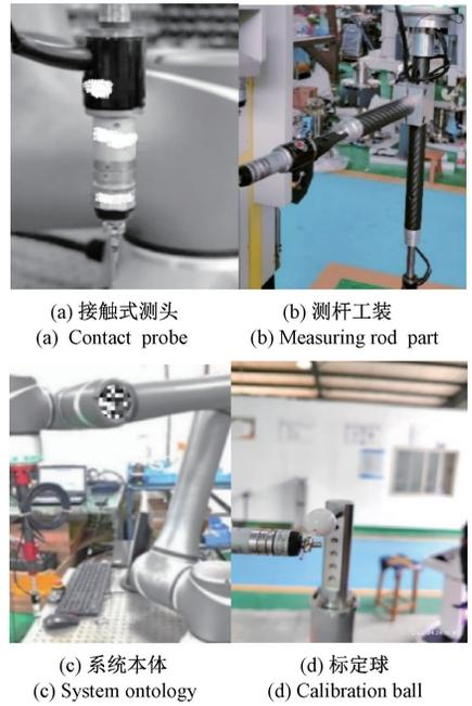
图4 接触式测量系统实验设备
