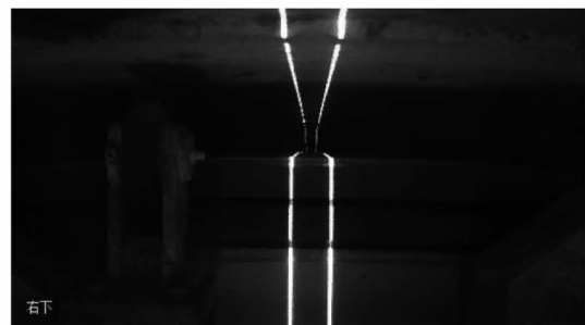
图 11 双线激光测量盾尾间隙
