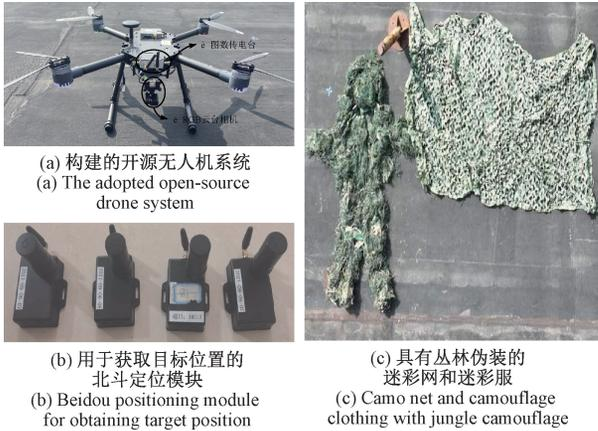
图 18 实验无人机及伪装目标设置
