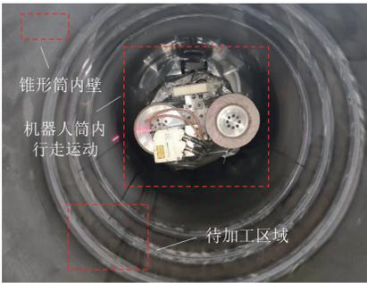
图 14 机器人管道内运动
