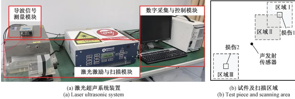
图 9 实验装置及测试示意图
