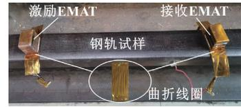
图 12 表面波检测踏面裂纹的实物图
