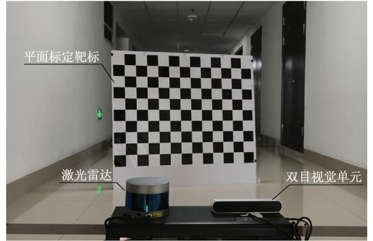
图 7 视觉-激光雷达测量单元及其标定靶标图
