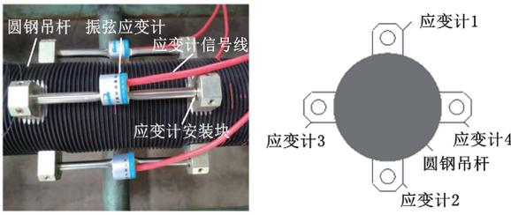
(c) 振弦应变计现场图及安装截面图
