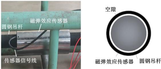
(d) 磁弹效应传感器现场图及安装截面图
