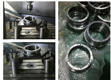
图 25 实际加工中进行热误差补偿
