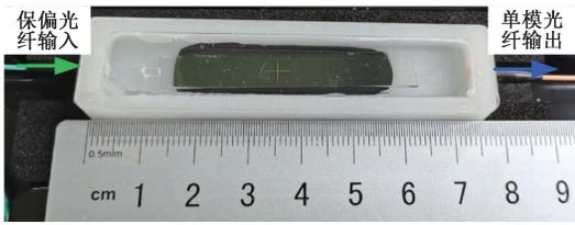
图3 集成光波导传感器实物照片
