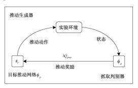
图 3 基于目标的推动网络模型
