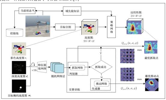
图 1 基于 GARL-DQN 的深度强化学习机器人操作技能框架
