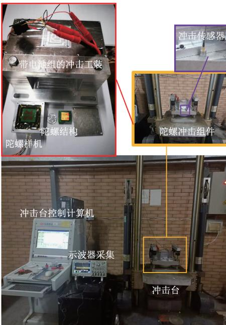
图 8 陀螺冲击实验平台照片
