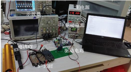
(b) 阈值电压测量电路
