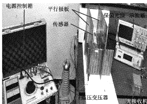
(b) 工频强电场测量系统照片
