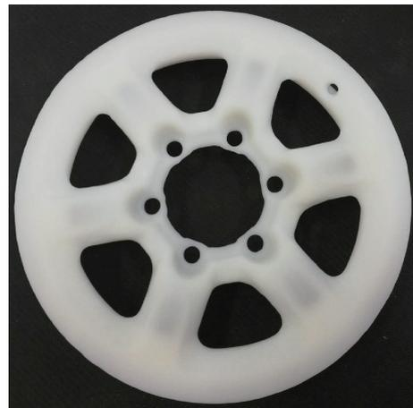
图 16 3D 打印轮毂模型
