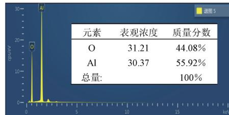
图 10 Al<sub>2</sub>O<sub>3</sub> 功能薄膜的能谱分析
