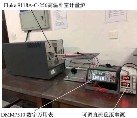
图 15 高温薄膜热流传感器标定现场
