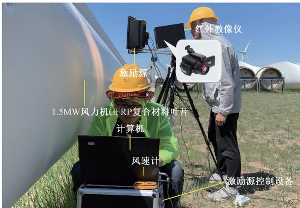
图7 红外热像检测设备
