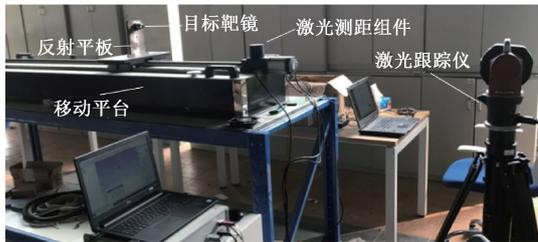
(b) 测距精度测试平台实际操作图
