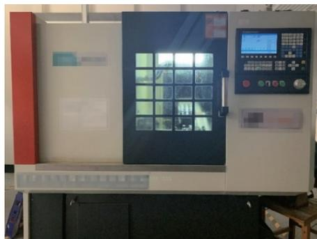
图 13 HXC32D 斜轨数控车床
