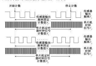
图 1 双频率同步采集方法原理
