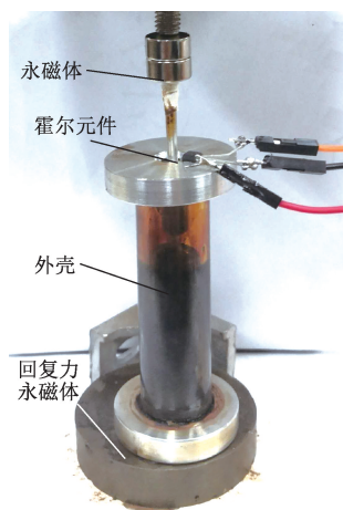
图 2 磁性液体触觉传感器样机
