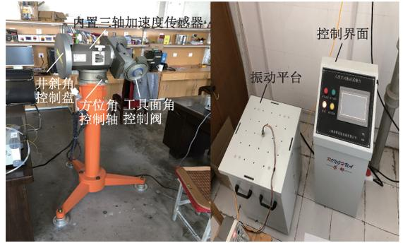
(a) 测斜仪调校装置 (a) Inclinomenter adjusting device (b) 六度空间振动实验台 (b) Vibration test bench
