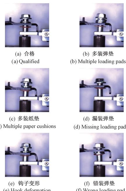
图 5 高度调节器右侧缺陷
