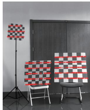
图 8 激光点云投影至像素坐标系
